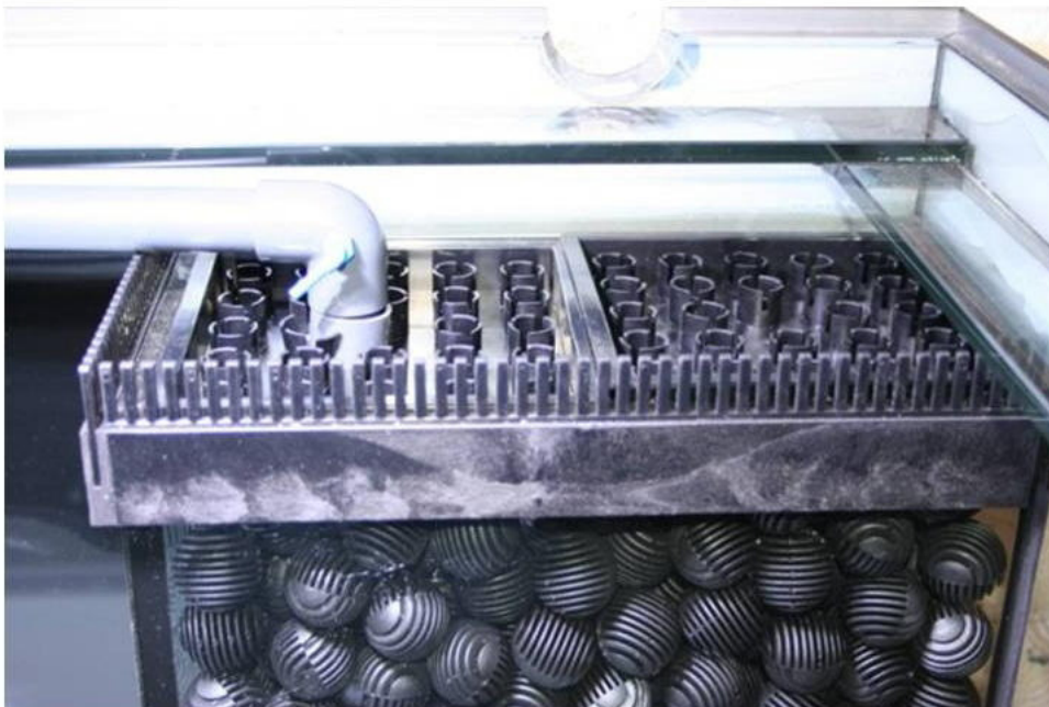
Abb. 1: Die richtige Einstellung der Rieselplatten, der Bactoballs und des 25 mm Rohres im Anthias Aquarium. Stellen Sie während des Betriebs sicher, dass das blaue Winkelstück sauber ist, da dieser Winkel einen Rücklauf des Aquariengewässers verhindert. Ein Rücklauf kann aufgrund von Stromausfällen auftreten oder wenn die Umlaufpumpe des Eco Runners 3700 abgestellt wird.
